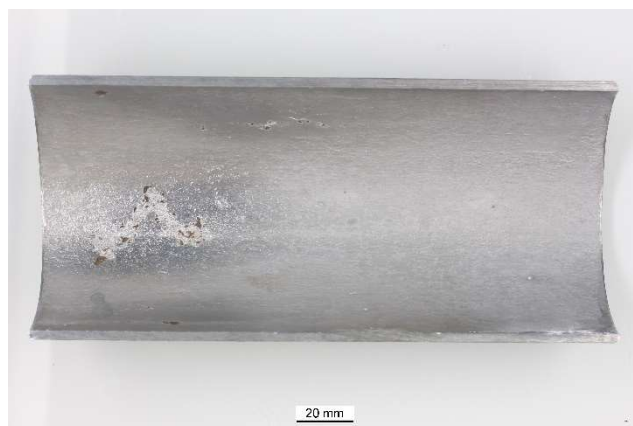
Gereinigtes Rohr mit Korrosionsnarbe
