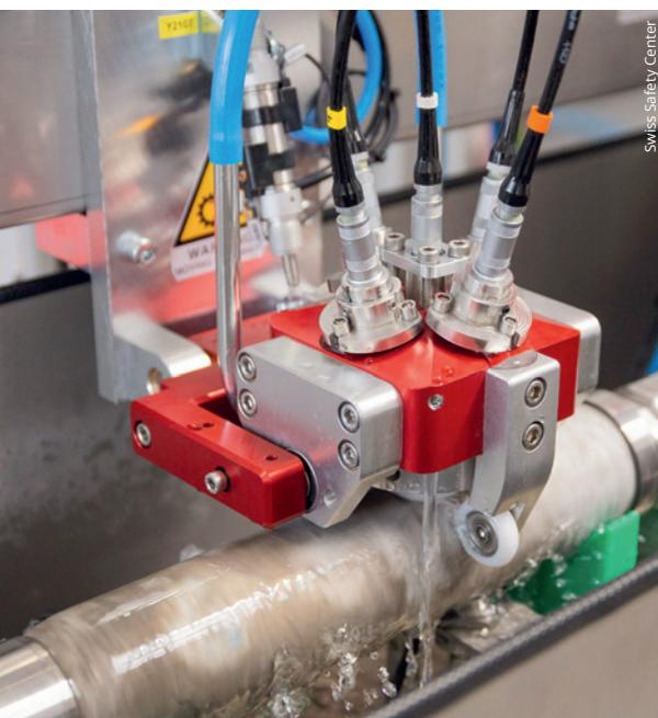
Eine Autosonic-Anlage des Swiss Safety Centers prüft CO<sub>2</sub>-Patronen für Wassersprudler.
