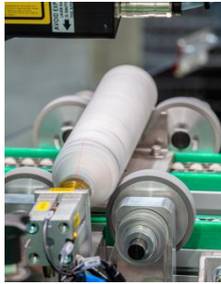
Autosonic™ mini+ Auto: Laser-3D-System für die Erkennung eingravierter Behälterdaten.
